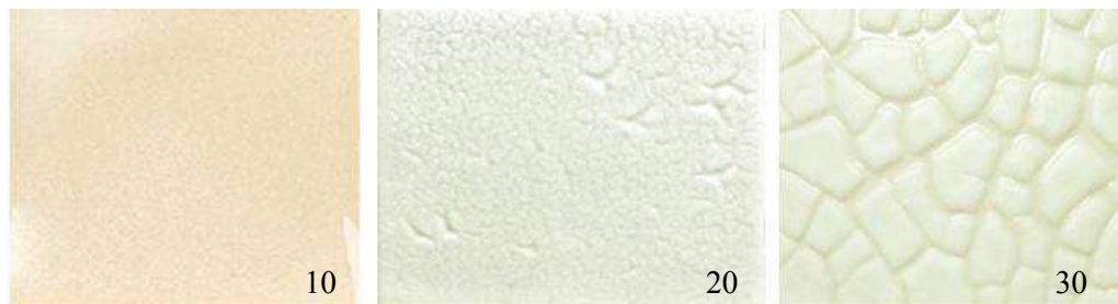
Фиг. 3. Базисната глазурата дотирана с ZrSiO_4 съответно 10 т.ч., 20 т.ч. и 30 т.ч. След изпичане. Глазурата, дотирана с 10 т.ч., е изпечена на 1020°C, другите две проби – съответно на 1070°C
