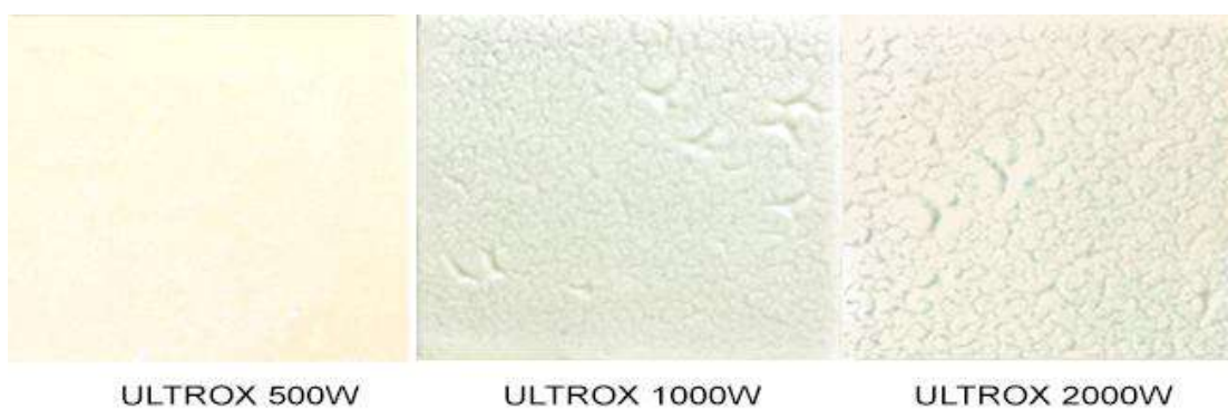
Фиг. 4. Базисната глазура, дотирана 20% съответно с Ultraox 500W , Ultraox 1000W и Ultraox 2000W , след изпичане на 1070^{\circ}C
