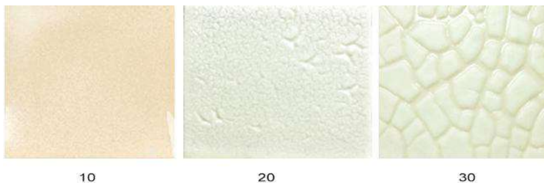
Фиг. 3. Базисната глазура, дотирана с ZrSiO_4 съответно 10 т.ч., 20 т.ч. и 30 т.ч. След изпичане. Глазурата, дотирана с 10 т.ч. е изпечена на 1020^{\circ}C , другите две проби съответно на 1070^{\circ}C
