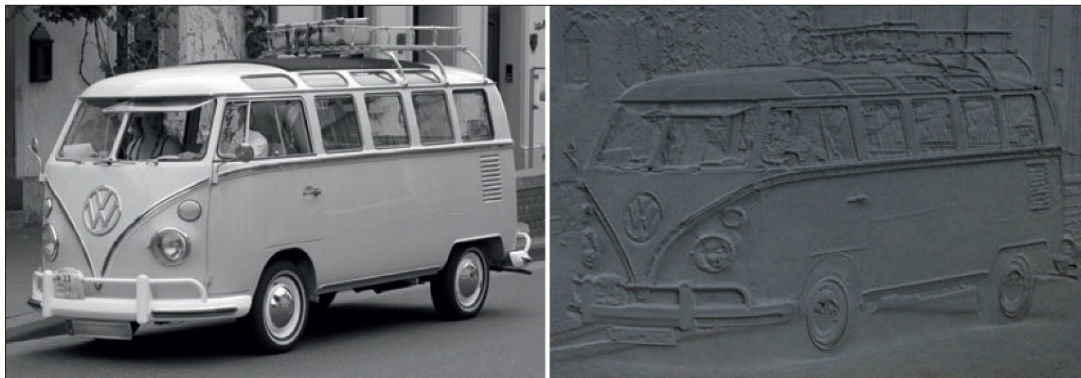
Фигура 4. Триизмерно изображение от бетон, постигнат чрез фотогравирание
