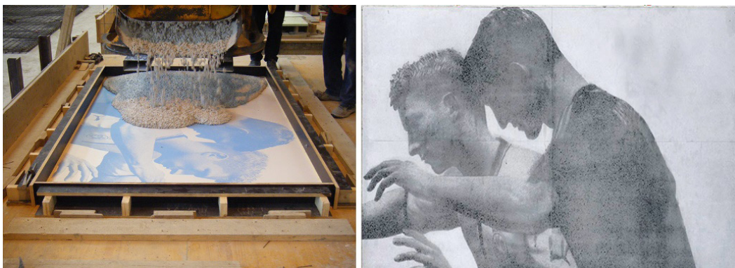
Фигура 2. Отливане на бетон върху фолио и полученото изображение след измиване
